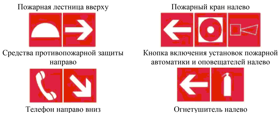
Рисунок 10 - Примеры формирования смысловой комбинации знаков для указания направления движения к эвакуационному выходу, средствам противопожарной защиты, месту сбора и средствам оказания первой медицинской помощи
